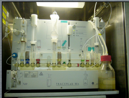
Module de synthèse du traceur PET (=précurseurs chimiques organiques + isotope \beta^+ venant du cyclotron)
